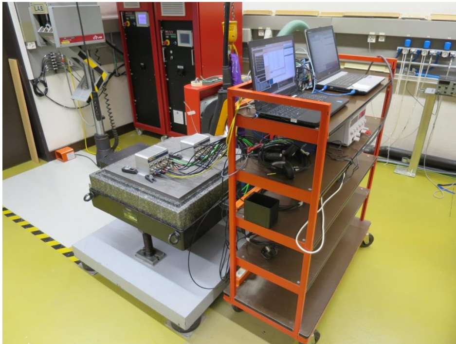
Fixation in X-direction / Aufspannung in X-Richtung
